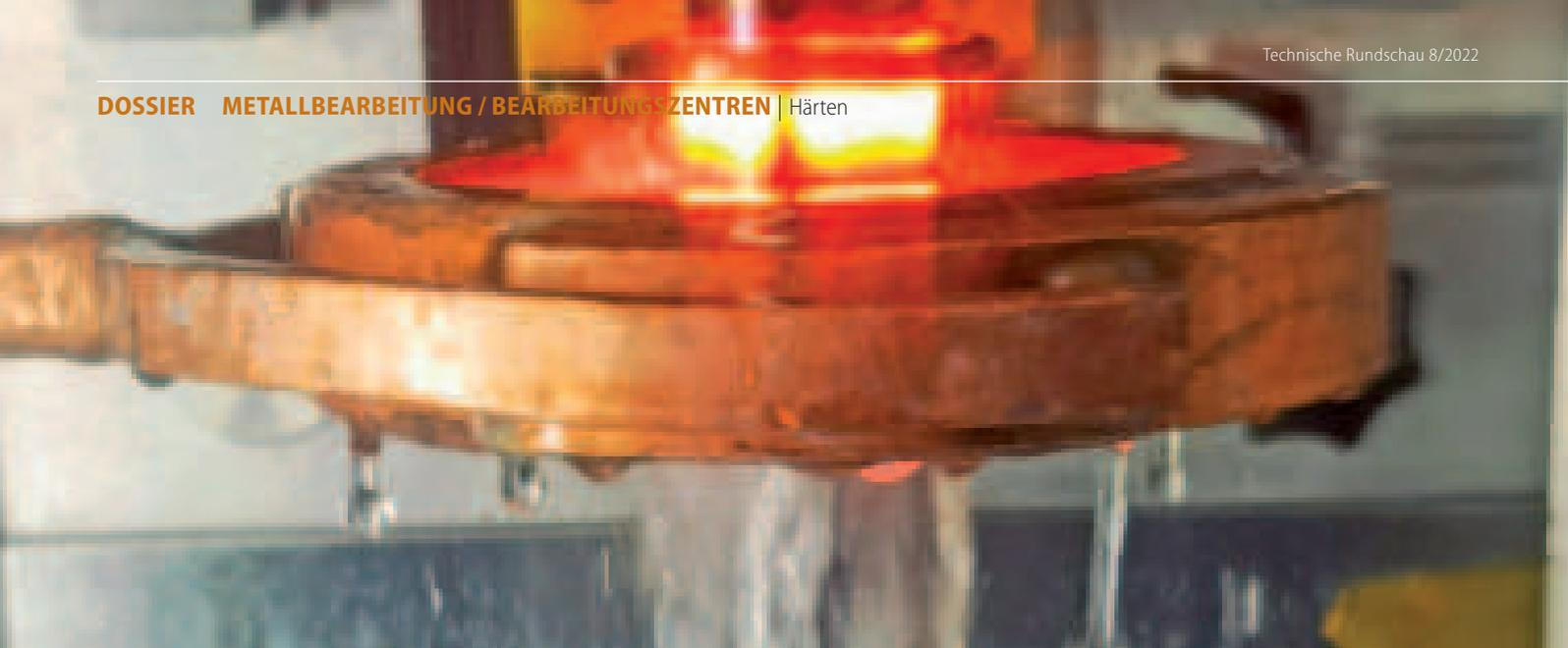
Automatisches induktives Randschichthärten des Bundes einer Welle im Durchlauf. Oben erzeugt der Induktor Rotglut, die rasche Abkühlung durch die nachfolgende Brause sorgt für die gewünschte harte Oberflächenschicht. (Bilder: Klaus Vollrath)
