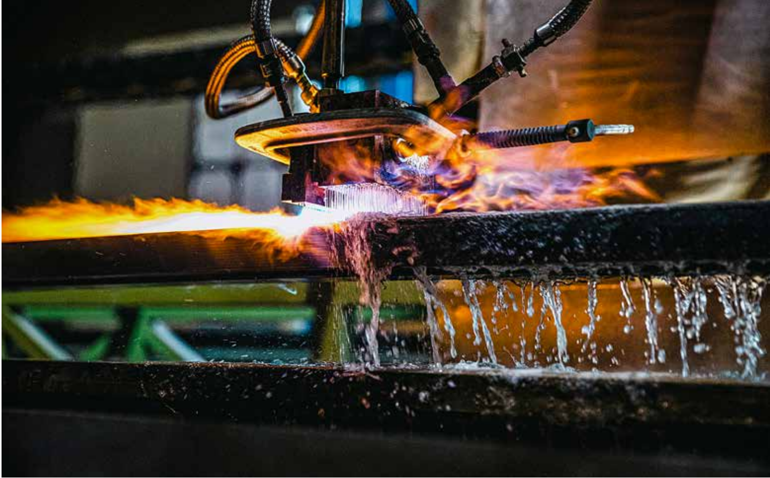
Flammhärten: Mittels speziellen Hochleistungsbrennern wird die Randzone mit Leistungen bis zu 2500 kW rasch auf Härtetemperatur gebracht und je nach Werkstoff mit Wasser, Polymerlösungen, Öl oder Druckluft abgeschreckt. Foto: Härterei Gerster
