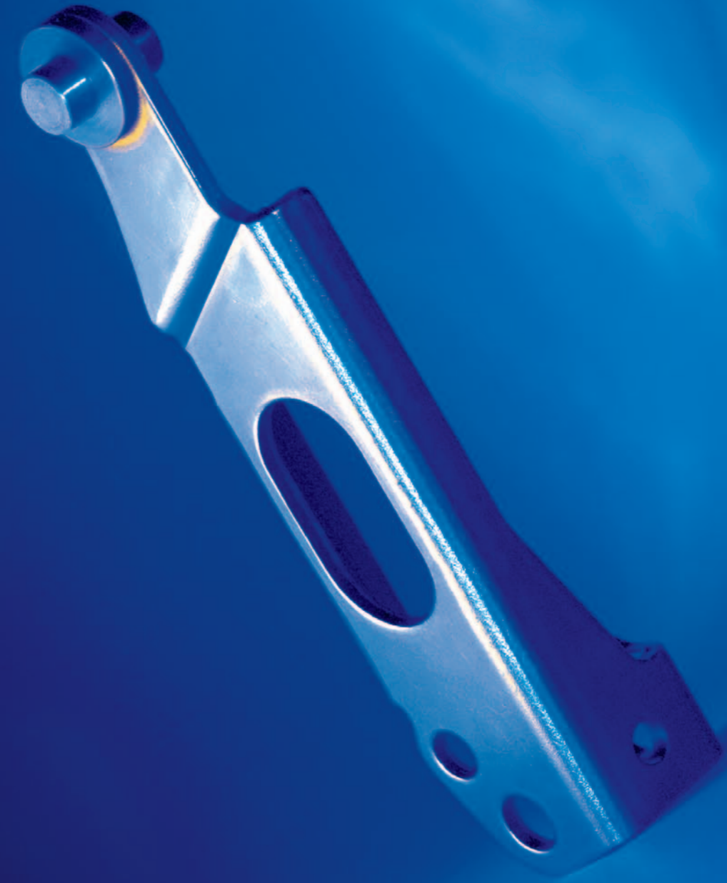
Hebel mit eingelötetem Bolzen. Die beiden Teile werden mit Kupfer unter Schutzgas gelötet und anschliessend einsatzgehärtet.
