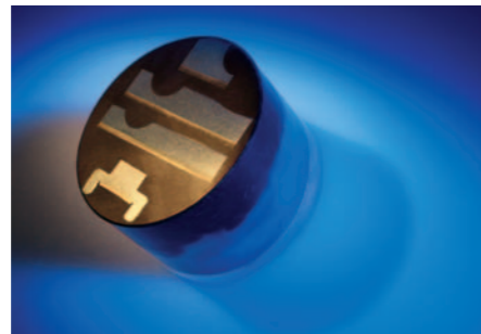
Quer- und Längsschliffe zur Kontrolle der Laserhärtung.
