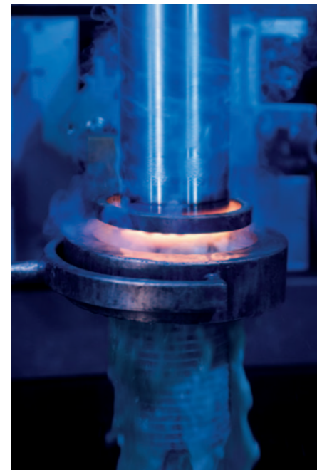
MF-Härtung einer 3,6 m langen Welle.
