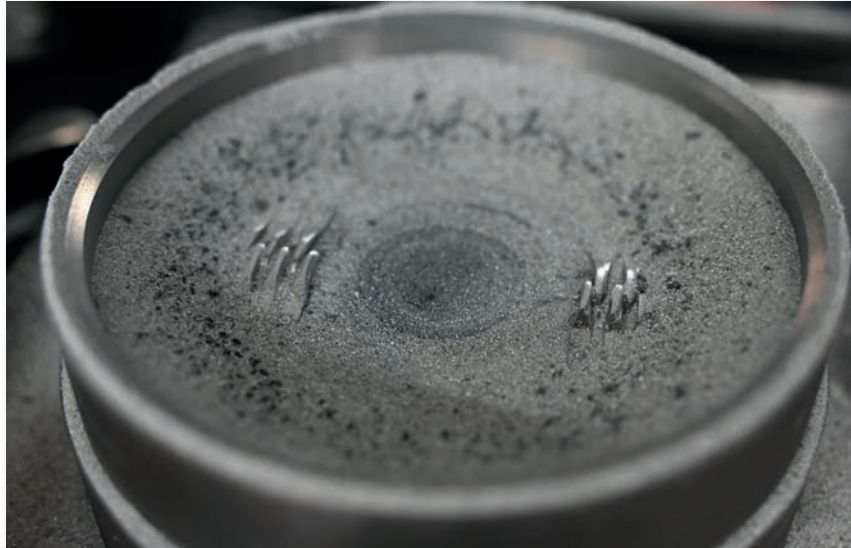
Bild 4: Topf mit Prüfteilen und Korund-Füllung.
