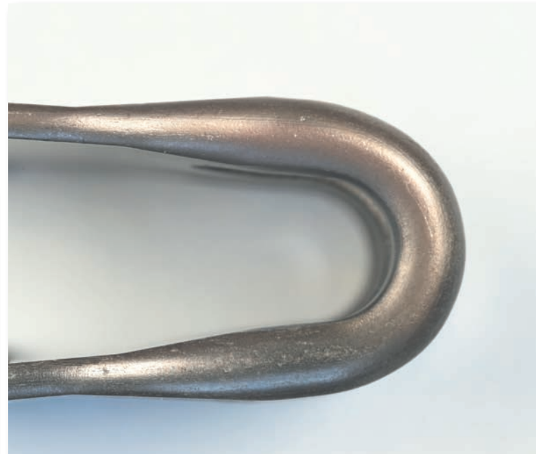
Bild 7d: Seitensicht eines HIS-behandelten Verbinders nach 48 Stunden.
