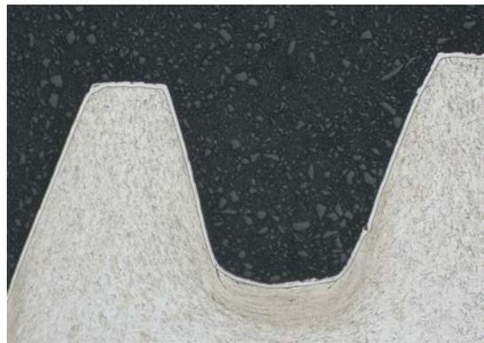
**Bild 8:** Schnitt durch das Gefüge einer Schraube aus 1.4401, die eine S-Phase (heller Saum) im Randbereich aufweist. Auffällig sind die deutlich sichtbaren Verformungslinien durch das Rollen im Gewindegrund.
