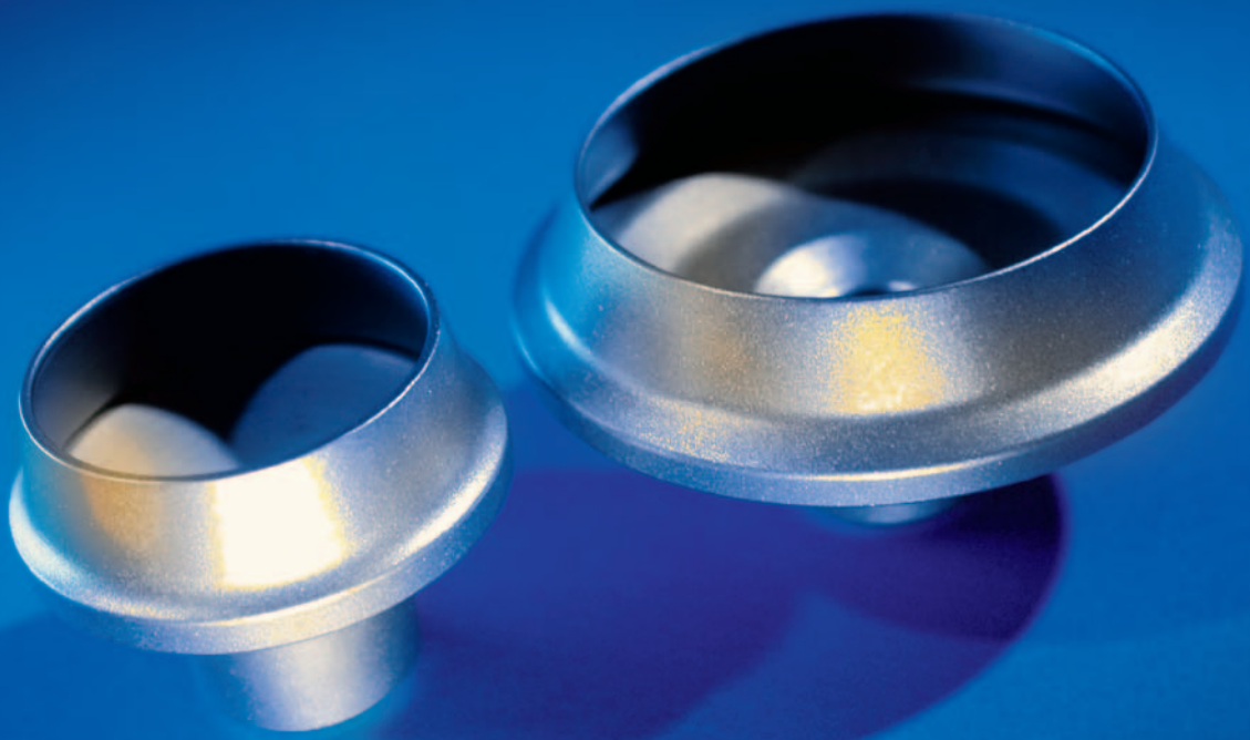
Textilmaschinenbau: Rotorbecher zur Fadenherstellung. Vergütungsstahl, partiell boriert, vergütet und beschichtet.
